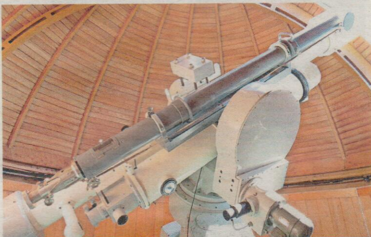
Kern-Koronagrafen huckepack montiert auf dem Zeiss-Koronagrafen (weiss) in der alten Kuppel.
